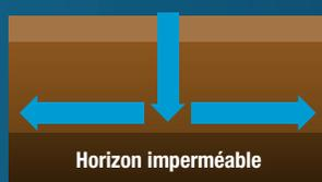
l'eau s'infiltré puis ruisselle sur une couche imperméable souterraine : type de sol différent ou semelle de labour.
