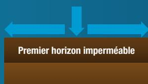
**// Par refus d'infiltration,** quand la surface du sol est fermée, à cause de phénomènes de battance ou de tassement du sol en surface.
