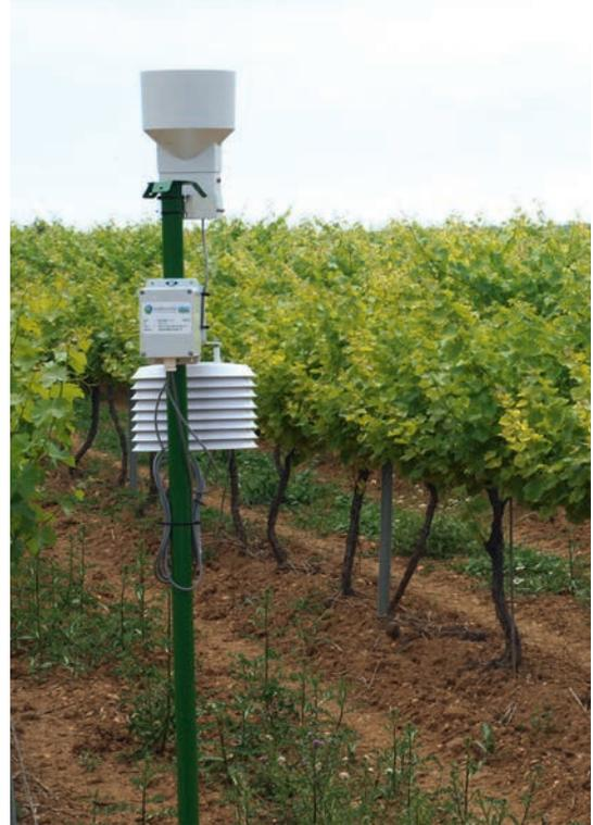
/ Station météo AGRISCOPE utilisée au Mas numérique. Les prévisions météo aident à une meilleure organisation des chantiers. Les capteurs pour la pluie et les températures renseignent les outils de modélisation.
