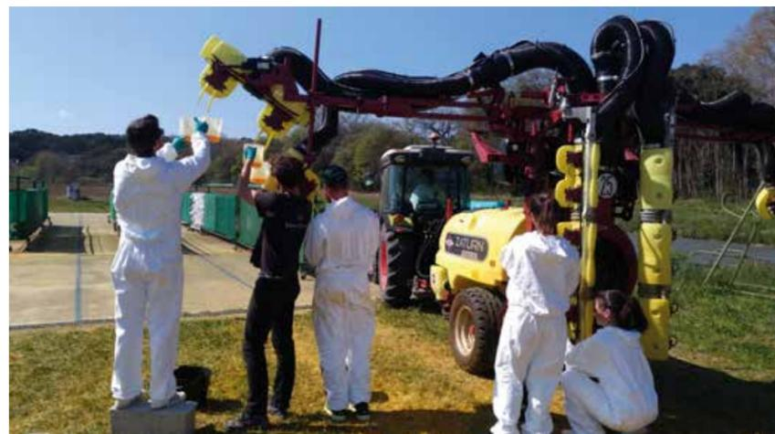
/ Expérimentation des pulvérisateurs sur vigne artificielle.
